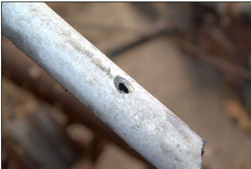
Фотографија 9: Место додира моторног змаја и жице далековода
